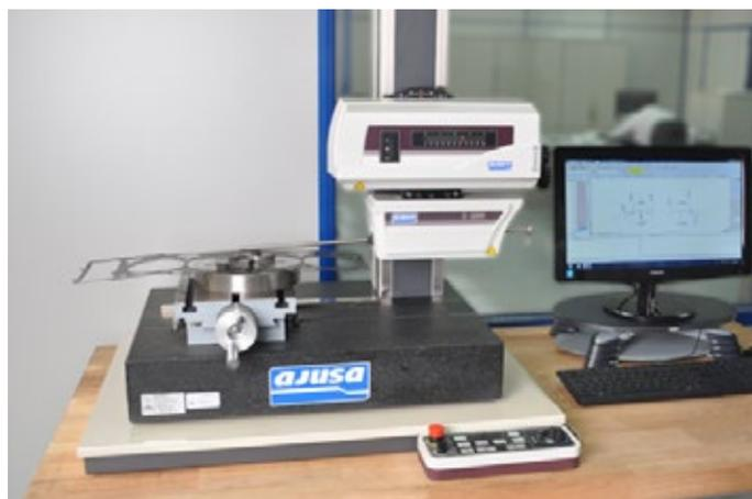
Así pues, se puede expresar la necesidad de tener una medición por contacto donde la precisión inferior a la micra de milímetro hace de esta herramienta fundamental tanto para el diseño como para la posterior verificación de las fabricaciones.
