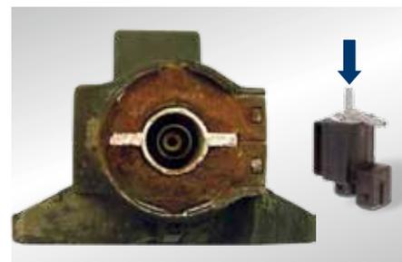
Clapet d'inversion électrique corrodé (ouvert)
