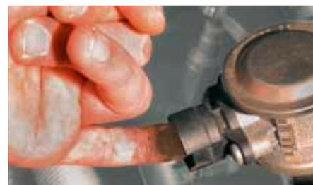
Essai au doigt au niveau de la valve d'air secondaire sur BMW 520i (en rouge) Si des dépôts sont présents de ce côté, le clapet anti-retour n'est pas étanche et doit être remplacé.
