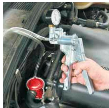
Contrôle d'une valve d'air secondaire avec une pompe à vide manuelle
