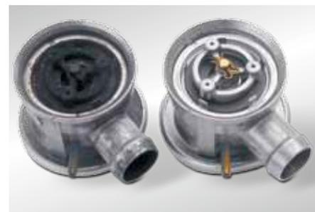
Valve d'air secondaire ouverte à gauche : dommages causés par du condensat de gaz d'échappement à droite : état neuf
