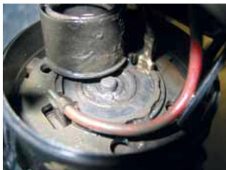
Présence de condensat de gaz d'échappement agressif dans le moteur d'entraînement d'une pompe à air secondaire
