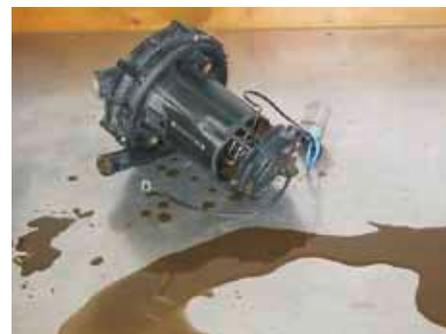
Présence de condensat liquide de gaz d'échappement issu d'une pompe à air secondaire
