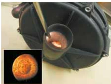
Vue de l'entrée corrodée d'une pompe à air secondaire
