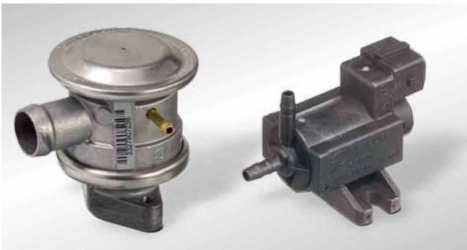
*Clapet anti-retour de coupure d'air secondaire commandé par dépression (depuis env. 1995) et clapet d'inversion électrique*
